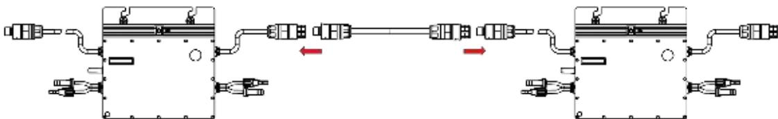
A) Installieren Sie die AC-Endkappe am offenen AC-Anschluss des letzten Mikrowechselrichters des Wechselstromkreises.
