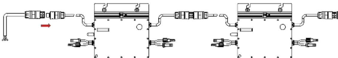
C) Schließen Sie die andere Seite des AC-Endkabels an den Verteilerkasten an und verbinden Sie es dadurch mit der hausinternen Installation.
