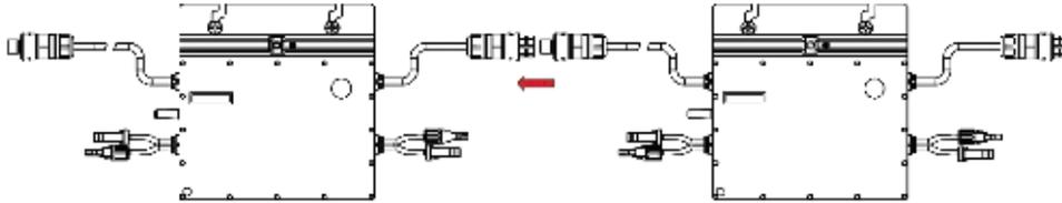
\* Anmerkung: Die Länge des AC-Kabels am Mikrowechselrichter beträgt etwa 2,06m. Wenn der Abstand zwischen zwei Mikrowechselrichtern mehr als 2m beträgt, so verwenden Sie bitte ein AC-Verlängerungskabel zwischen den beiden Mikrowechselrichtern (wie in der Abbildung unten dargestellt).
