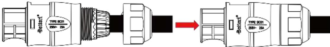
B) Schließen Sie das AC-Endkabel an den AC-Anschlussstecker des ersten Mikrowechselrichters an, um den Stromkreis fertigzustellen.
